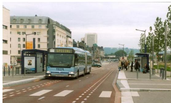
Ein spurgeführter Streckenabschnitt im Bussystem TEOR
