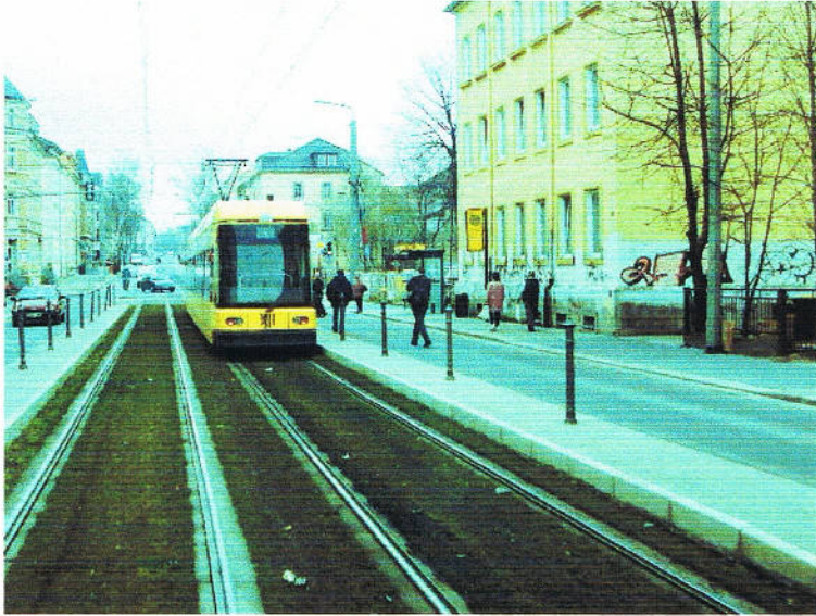
Stadtbahn Dresden: Haltestelle in Straßenmitte ohne Haltestelleninsel und unkonventionellem niveaugleichem Einstieg von der 'hochgepflasterten' Straßenoberfläche
